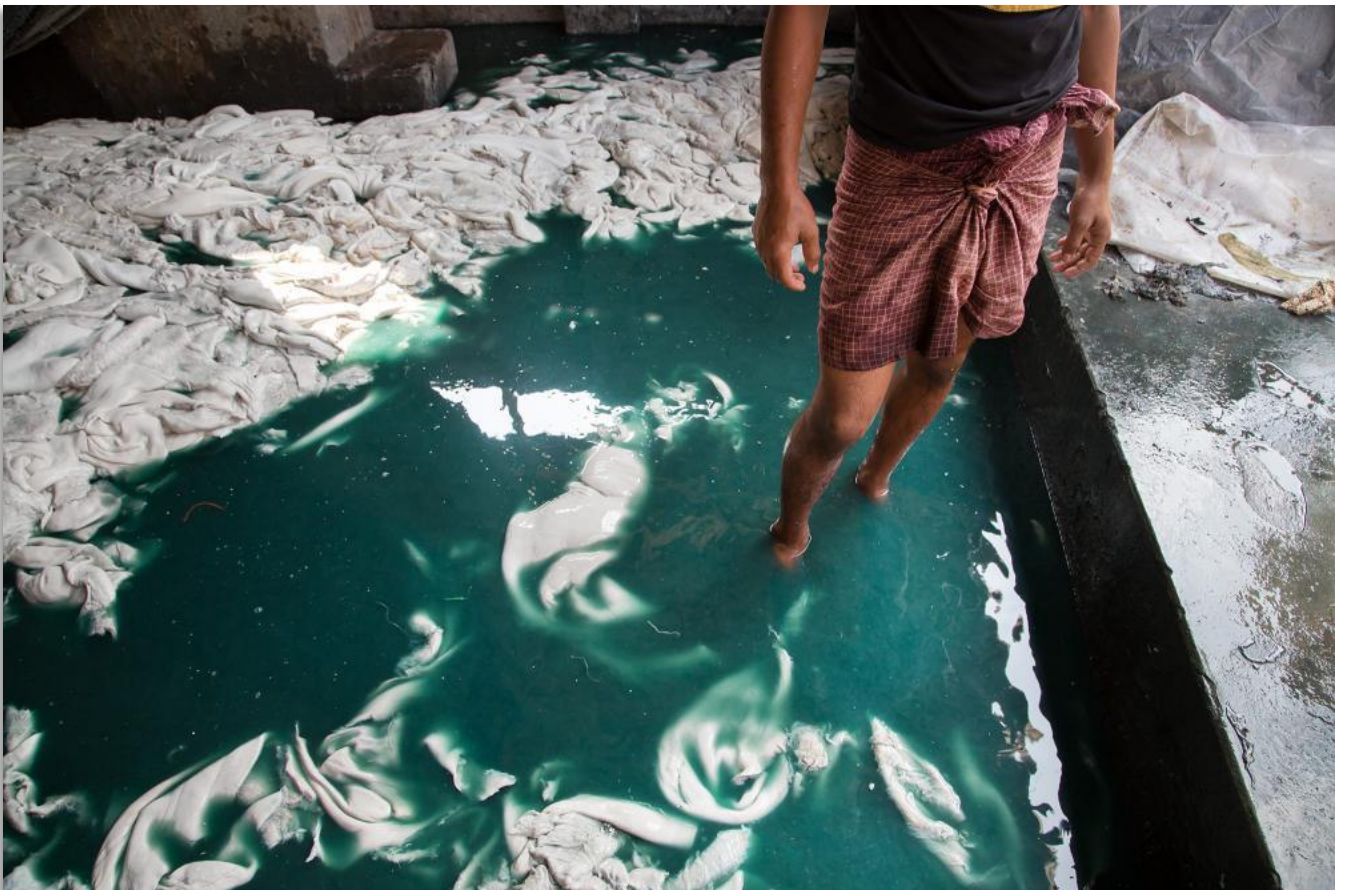
↑ Travaux dans l'un des bassins contenant du métabisulfite de sodium et du chlorure d'ammonium ( site )
